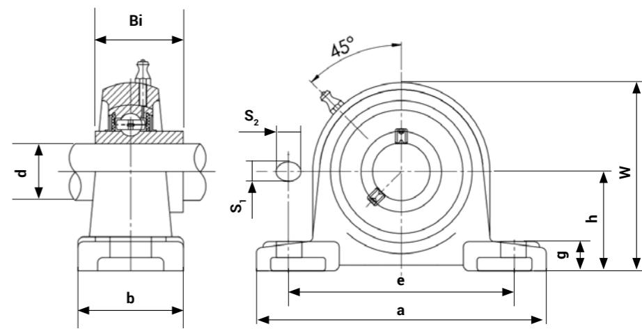
Выдерживают высокие радиальные нагрузки и крепятся на вал с помощью зажимной втулки.
