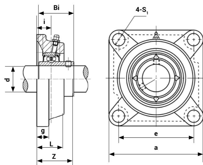
Узлы серии UKF имеют квадратную форму фланца. Крепятся с помощью зажимной втулки. Опорная поверхность идёт строго перпендикулярно оси вращения самого подшипника. Отличаются малошумностью. Предназначены для работы при больших скоростях вращения с необходимостью обратного хода.
