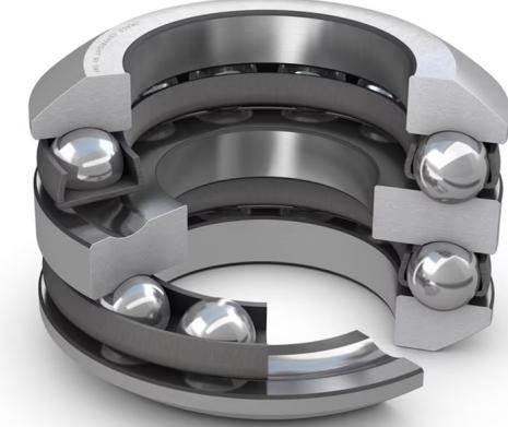
Двойные упорные шарикоподшипники предназначены для восприятия осевых нагрузок, действующих в обоих направлениях. Данные подшипники не должны подвергаться радиальному нагружению. Их разъёмные компоненты облегчают монтаж/демонтаж и техническое обслуживание. Многие компоненты взаимозаменяемые. Тугие кольца имеют шлифованное отверстие для посадки с натягом.
