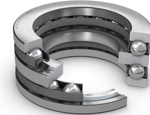
Двойные упорные шарикоподшипники предназначены для восприятия осевых нагрузок, действующих в обоих направлениях. Данные подшипники не должны подвергаться радиальному нагружению. Их разъёмные компоненты облегчают монтаж/демонтаж и техническое обслуживание. Многие компоненты взаимозаменяемые. Тугие кольца имеют шлифованное отверстие для посадки с натягом.
