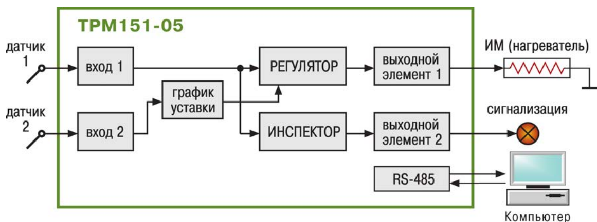
Рисунок 4.8 – Принципиальная схема модификации 05 прибора TPM151
