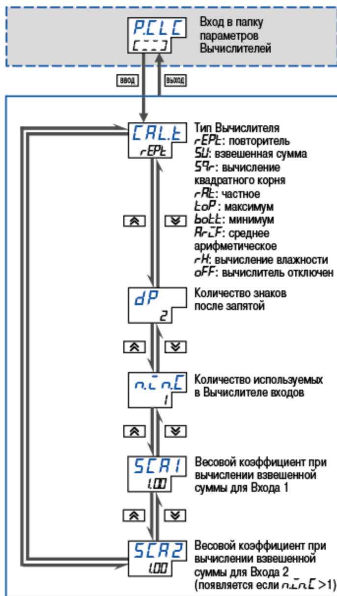
Рисунок 12.17 - Схема задания параметров Вычислителей
