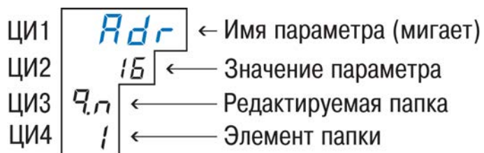
Рисунок 12.3 – Показания цифровых индикаторов при задании параметров
