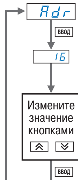
Рисунок 12.5 – Схема изменения параметра
