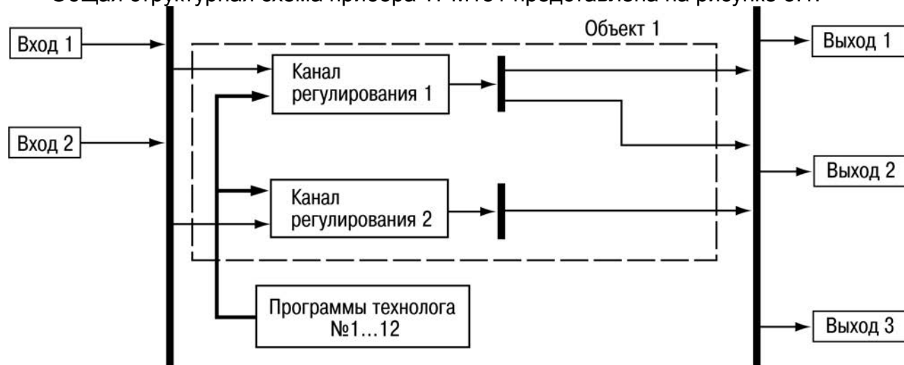
Рисунок 3.1 – Структурная схема прибора TPM151
