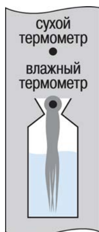
Рисунок К.3 – Форма резервуара с «бутылочным горлом»
