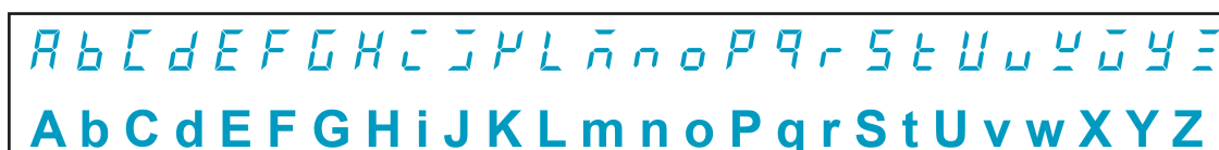
Рисунок 8.7 – Соответствие начертания символов на цифровом индикаторе буквам латинского алфавита
