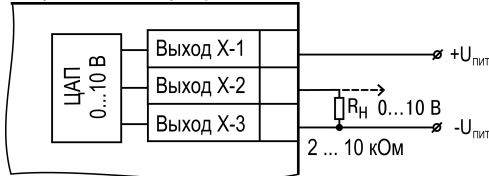
Рисунок 20 – Схема подключения нагрузки к ВУ типа У
