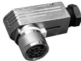
Гнездовой кабельный разъем, прямоугольный, для кабеля диаметром 6-8 мм, окончание: припой или обжим. Размер A = 57,5 мм
