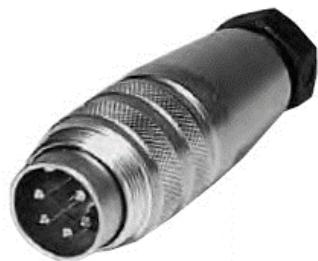
Штекерный кабельный разъем, прямой, для кабеля диаметром 6-8 мм, окончание: припой или обжим, покрытие контактов: серебро
