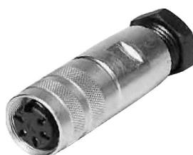
Кабельный разъем-розетка, прямой, для кабеля диаметром 6-8 мм, окончание: припой или обжим, покрытие контактов: серебро.
