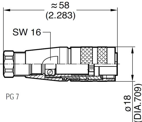
Кабельный разъем-розетка, прямой, для кабеля диаметром 6-8 мм, окончание: припой или обжим, покрытие контактов: серебро.
