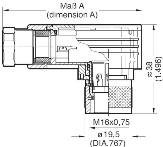
Гнездовой кабельный разъем, прямоугольный, для кабеля диаметром 6-8 мм, окончание: припой или обжим. Размер A = 57,5 мм
