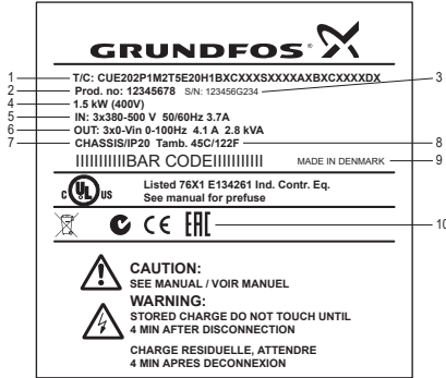
Նկար 3 Հաճախության կերպափոխիչի ֆիրմային վահանակը
