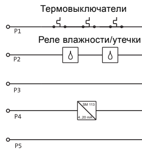
Рис. 25 Исполнение с датчиками 2 (термовыключатели) и взрывозащищенное исполнение 2
