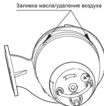
Рис. 22 Отверстия для заливки масла
