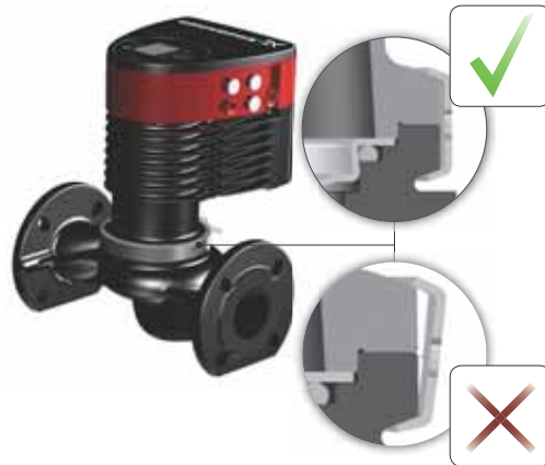
Рис. 9 Закрепление головной части насоса на корпусе насоса
