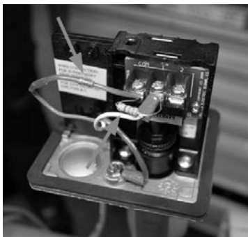
3-сур. Қысым релесі корпусына кедергілерді (резисторлар) орнату мысалы
