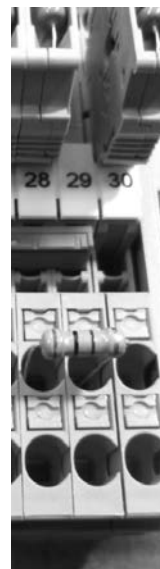
4-сүр. РТС билдиргичин туташтыруу клеммаларында каршылыкты (резисторду) орнотуунун мисалы
