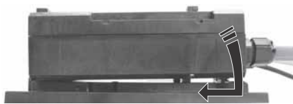
Рис. 7 Установка модуля E-Box на монтажной плите
