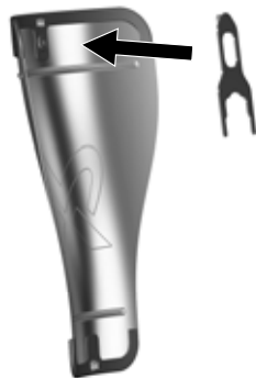
Рис. 7 Установка регулировочной вилки F с обратной стороны защитного кожуха муфты (7)
