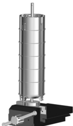
Рис. 18 Установка комплекта камер на приспособлении Н1
