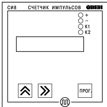
Рисунок 6.6 – Лицевая панель прибора для корпусов настенного (Н) и щитового (Щ1) креплений
