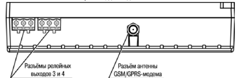
Рисунок 3.2 – Вид на верхнюю поверхность ПЛК323.ТЛ
