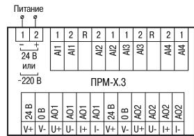
Рисунок 3 – Назначение контактов клеммника
