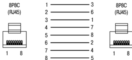
Рисунок В.7 – Кабель Ethernet crossover
