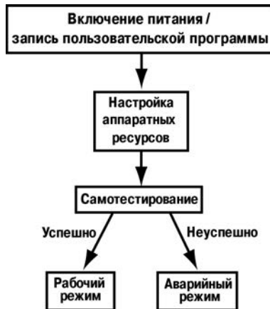
Рисунок 3.1 – Алгоритм запуска прибора
