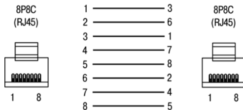
Рисунок В.7 – Кабель Ethernet crossover
