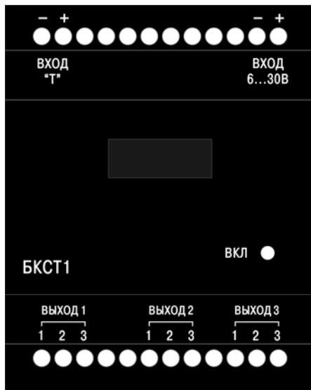
Рисунок А.2 - Внешний вид лицевой панели БКСТ1
